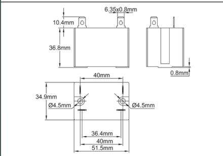
1 × 30 A 250 V resistivo (AC1) (CE y UL) Contacto NC, carcasa sellada, terminales de 6,35 × 0,8. Este relé se puede montar sin placa de montaje directamente en todos los frentes de plástico activados previstos para termostatos de bulbo y capilar y controladores electrónicos, y en los frentes planos de las cajas de distribución de este catálogo. Bobina 200-240 VAC
