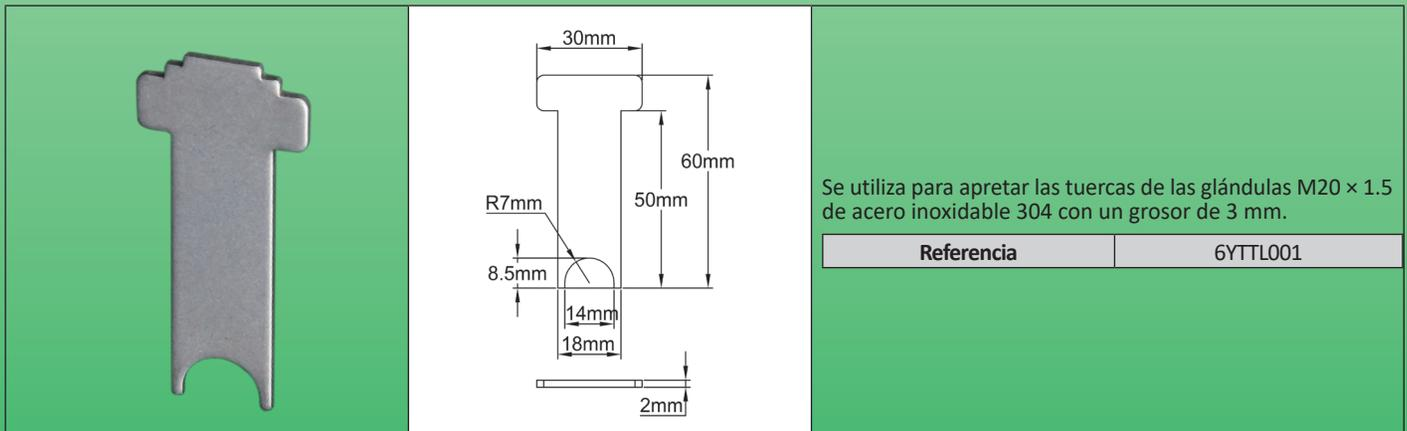
Se utiliza para apretar las tuercas de las glándulas M20 x 1.5 de acero inoxidable 304 con un grosor de 3 mm.
