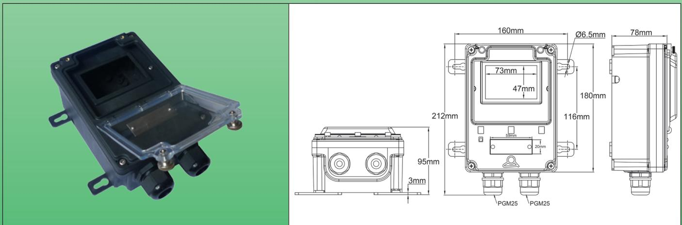
Permite el montaje de un interruptor automático tipo Merlin Gerin Multi 9 (UL, CSA, IEC) y gamas europeas equivalentes Vigi C60 o C60 (ancho máximo de 72 mm = cuatro módulos de 18 mm), o controladores electrónicos descritos en este catálogo.
