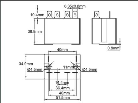
2 × 25 A 250 V resistivos (AC1) (CE y UL) Contacto NC, carcasa sellada, terminales de 6,35 × 0,8. Este relé se puede montar sin placa de montaje directamente en todos los frentes de plástico activados previstos para termostatos de bulbo y capilar y controladores electrónicos, y en los frentes planos de las cajas de distribución de este catálogo. Bobina 200-240 VAC
