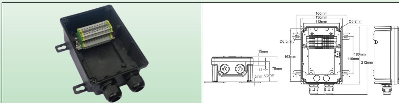
Tapa negra opaca. El riel, con un ancho claro de 80 mm (100 mm para regletas ubicadas a menos de 50 mm sobre el riel), permite el montaje de:
