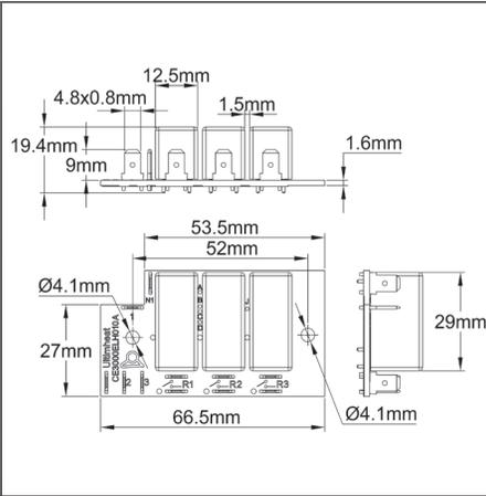
Placa de circuito electrónico de relé, 3 relés 16 A 250 V. Diseñada para cajas que contienen un termostato de control monopolar o un controlador electrónico con o sin opción de reinicio manual. Están disponibles en configuraciones de 1 a 3 relés, sin contactos. Las bobinas de relé se alimentan individualmente, 220-240 V. Terminales de 4,8 × 0,8.
