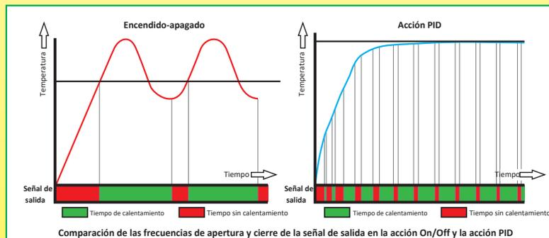
Si bien la acción PID puede mejorar el control en varias configuraciones, el inconveniente es que la señal de salida ciclará muy rápidamente, lo que reduce extensamente la durabilidad del relé de potencia y requiere en la mayoría de los casos el uso de relés de estado sólido.
