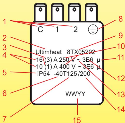
1: Identificación de terminales que son adecuados para la conexión de conductores externos, y si son adecuados para conductores de línea o neutro, o ambos.
