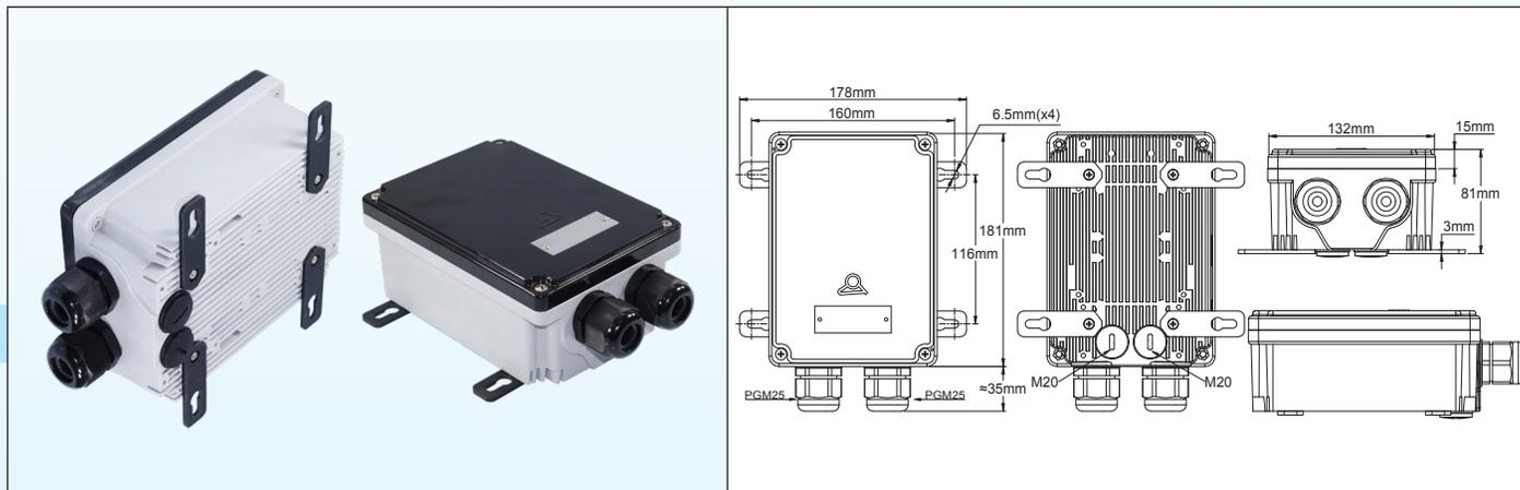
Estas cajas de aluminio selladas están pintadas con epoxi RAL 7015. Tienen las mismas dimensiones que las cajas de control de plástico y utilizan tapas planas. Utilizan las mismas lengüetas de montaje en pared que los modelos de plástico. Han sido diseñadas para el montaje de relés de estado sólido monofásicos o trifásicos cuya refrigeración se realiza mediante las aletas en la cara posterior.
