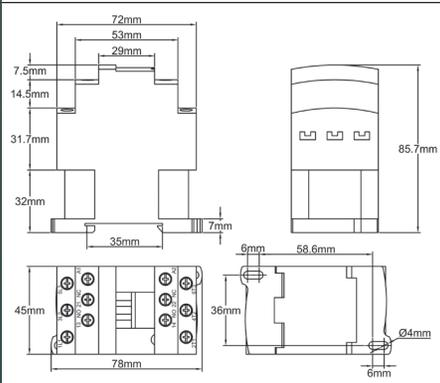
3 × 25 A o 3 × 32 A 250/400 VAC resistivo (AC1), terminales roscados, bobina de 240 VAC o 400 VAC.
