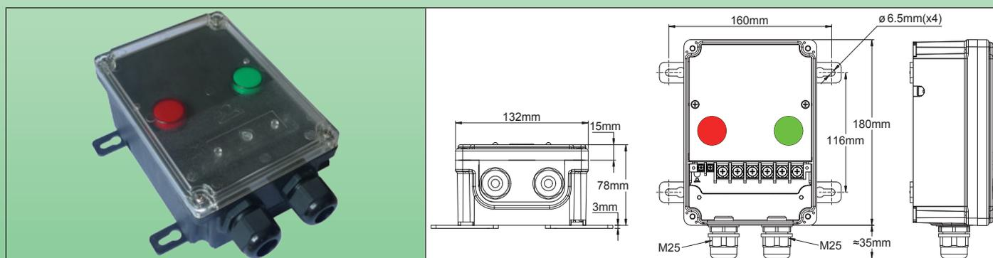
3 × 25 A (AC1), 250 V, regleta con 2 terminales de 2,5 mm<sup>2</sup> con tornillos y 6 terminales roscados de 10 mm<sup>2</sup>. Indicador rojo del suministro de energía y luz verde de salida (250 V), tapa transparente.
