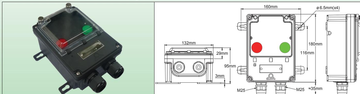
3 × 16 A (AC1), 250 V, regleta con 5 terminales de 2,5 mm<sup>2</sup> con tornillos y 5 terminales roscado de 6 mm<sup>2</sup>. Indicador rojo del suministro de energía y luz verde de salida (250 V), ventana transparente.
