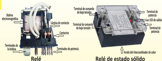
**El relé o contactor electromecánico:** La bobina está hecha de un gran número de vueltas de un cable de cobre muy delgado. Cuando pasa suficiente corriente por la bobina, produce un campo magnético que atrae la parte móvil y mueve las láminas con contactos eléctricos. Cuando la corriente ya no fluye en la bobina, los contactos regresan a su posición inicial gracias a un resorte restaurador.
