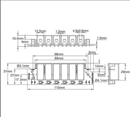
Tarjeta electrónica de relé 6 relés 16 A 250 V. Están disponibles en configuraciones de 4 a 6 relés, sin contactos. Las bobinas de relé se alimentan individualmente, 220-240 V. Terminales de 4,8 × 0,8.
