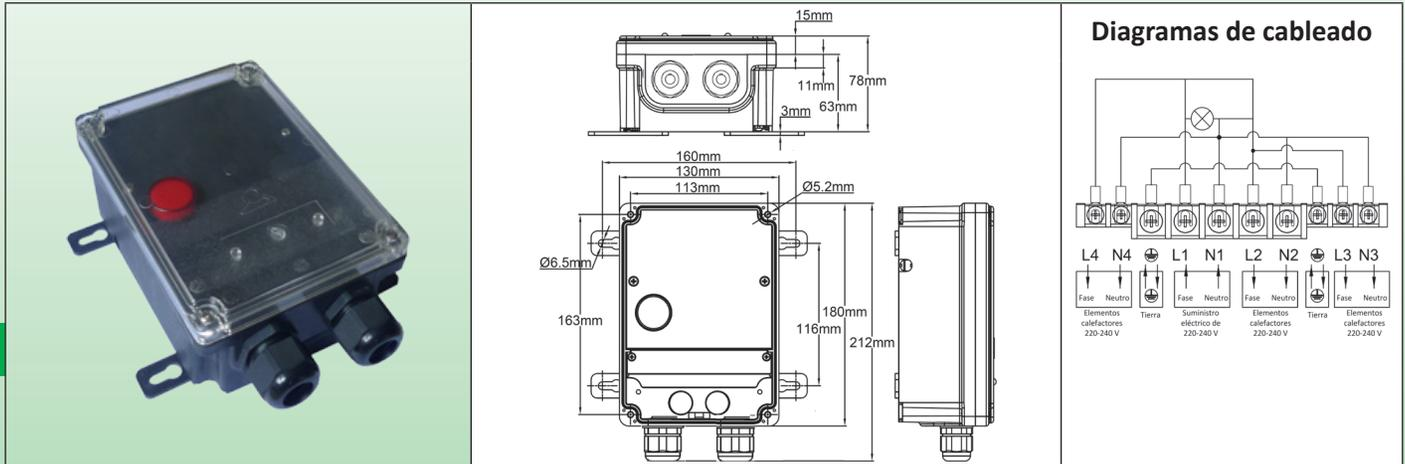
**Cableado:** Neutro + Fase + Tierra del suministro de energía en una regleta de 6 mm<sup>2</sup> y salidas a 3 salidas de circuito de calefacción de 1,5 o 2,5 mm<sup>2</sup>.
