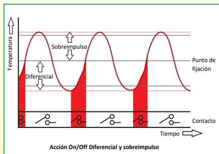
**Diferencial ajustable:** A menudo, un diferencial bajo se asocia con precisión en el control. Sin embargo, un diferencial demasiado bajo provocará ciclos cortos de calefacción y desgaste prematuro de los contactos si se utiliza un relé de potencia, o una rápida degradación del compresor si se utiliza el sistema para controlar un refrigerador. Los controladores electrónicos en este catálogo tienen un diferencial ajustable para optimizar esta operación.
